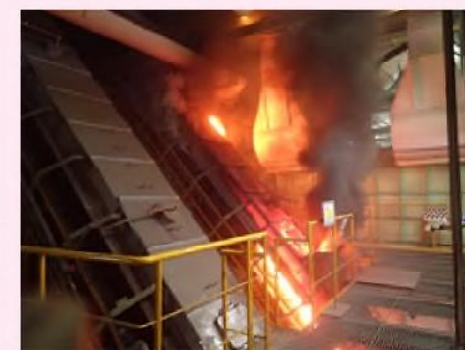
二次電池によるコンベア火災(中防不燃ごみ処理センター)
