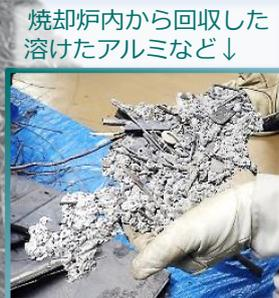
焼却炉内から回収した溶けたアルミなど ↓
