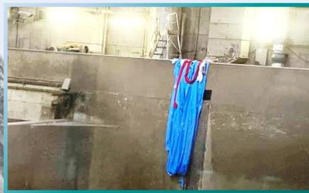
↑ 焼却炉へ投入する前に回収した規定寸法を超える長尺シート
