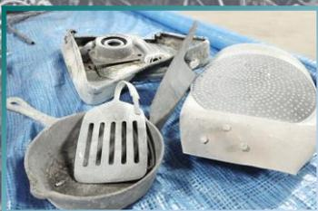
↑ 焼却炉内から回収した金属類 ←
