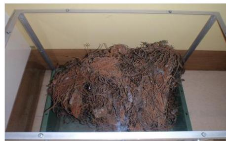
清掃工場の機械に絡まった金属類
