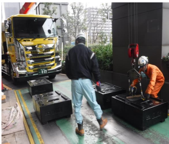
検査用の重りをごみ計量機に乗せています
