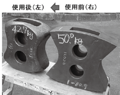
約2か月の破砕量は約9,000トンで、鑄鉄製のハンマーがこんなに擦り減ります。
