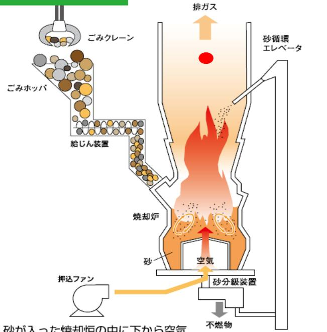
砂が入った焼却炉の中に下から空気を吹き込むと、砂は沸騰したお湯のように踊りだします。この状態の砂を熱し、その中にごみを投入して燃焼させます。
