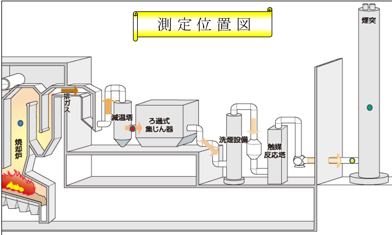
(注) : 図中(焼却炉側より)、● 燃烧室ガス温度、● ろ過式集じん器入口ガス温度、● 一酸化炭素濃度を連続計測する測定位置を示します。また、● 煙突中段では第三者機関により、ばい煙濃度(ばいじん、窒素酸化物、硫黄酸化物、塩化水素、水銀)及びダイオキシン類濃度を定期測定する測定位置です。
