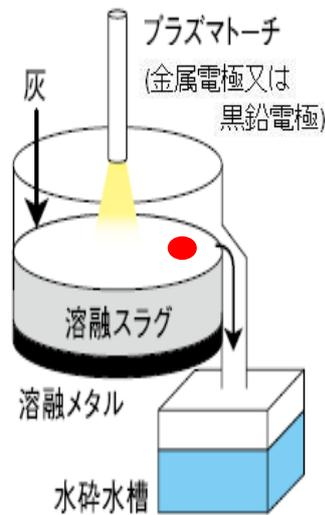
高い電圧をかけた筒状の電極に空気などを通してプラズマをつくり、噴射します。プラズマは高温で、その熱で灰を溶融します。
